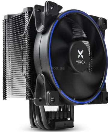
Рисунок 1.3 Кулер який встановлюється на процесор
