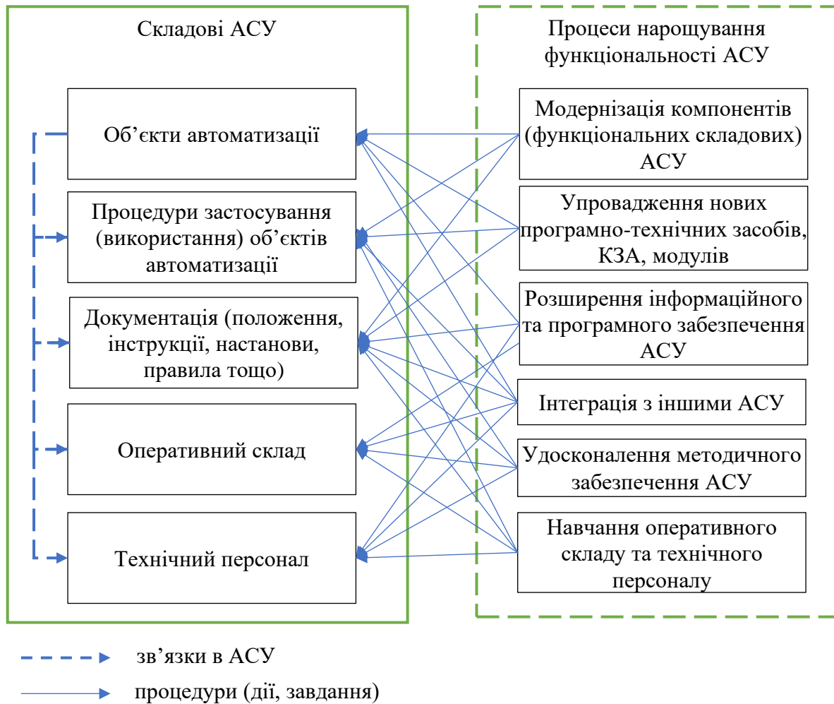
Рисунок 1. Складові АСУ та процеси нарощування функціональності
