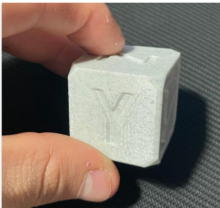
Рис А.1 – Результати попереднього друку стандартизованих моделей класичною конфігурацією fdm 3d-принтера
