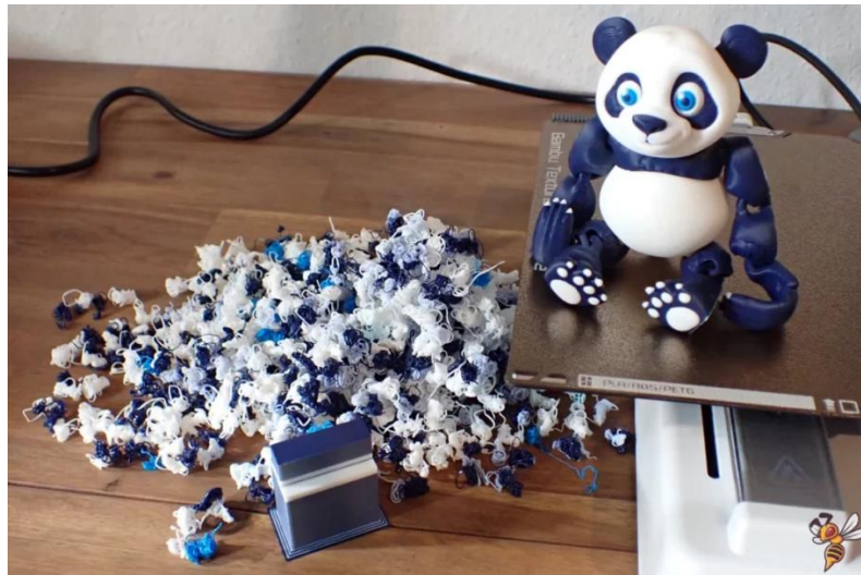
Рисунок 1.3 – Результат друку кольорової моделі на однокструдерному користувацькому принтері Vatoolab
