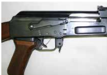
• Автомат встановлений на запобіжник
