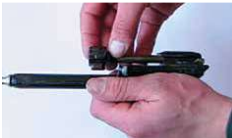
• Від'єднання затвора від затворної рами
