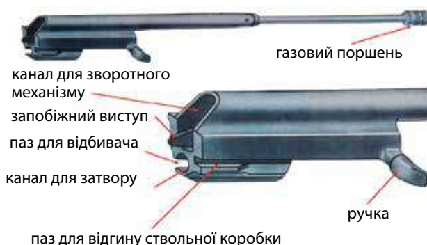
• Затворна рама з газовим поршнем
