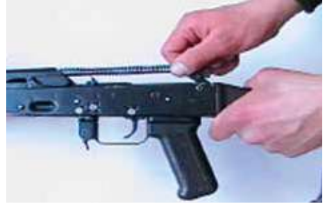
• Від'єднання зворотного механізму
