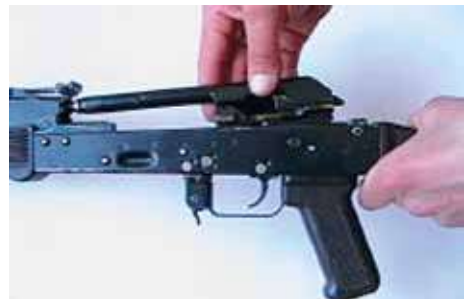
• Від'єднання затворної рами з затвором
