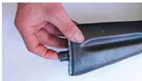
• Виймання пенала з гнізда приклада
