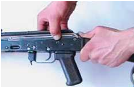
• Від'єднання кришки ствольної коробки
