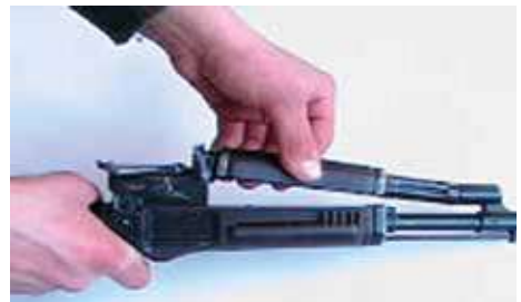
• Від'єднання газової трубки зі ствольною накладкою
