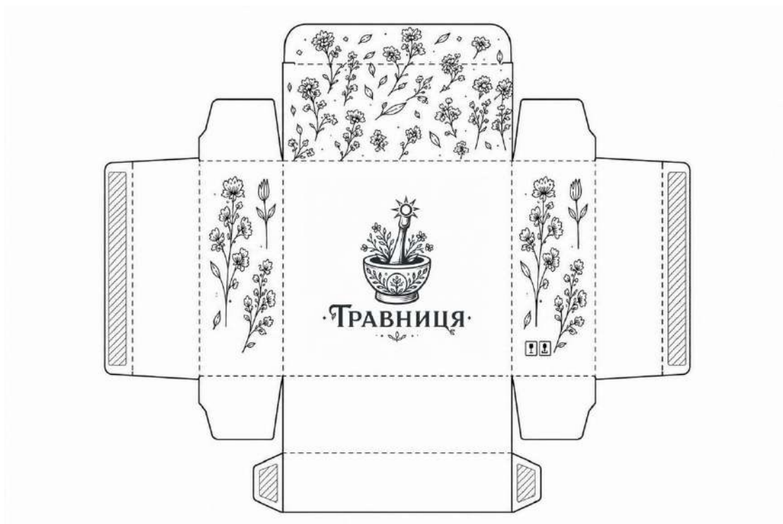
Рис. 3.4. Технічна розгортка поштової коробки з елементами фірмового маркування.
