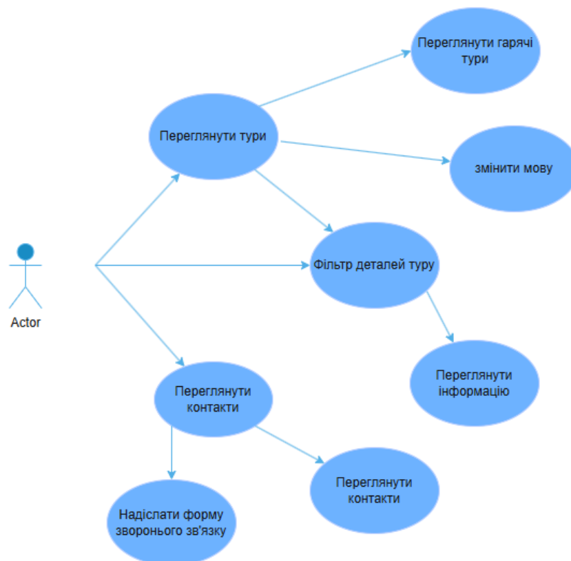
Рис. 2.8 — Діаграма варіантів використання Use Case Diagram.
