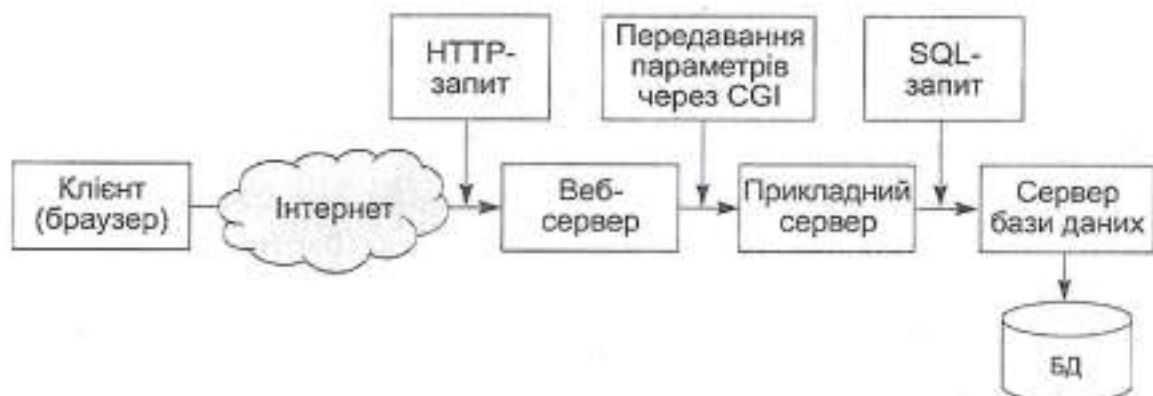
Рис. 1.1. «Схема взаємодії клієнта, веб-сервера та сервера баз даних»
