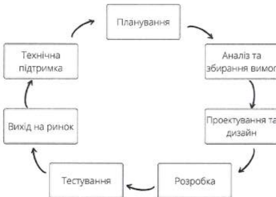
Рис. 2.2 «Цикл розробки програмного забезпечення»
