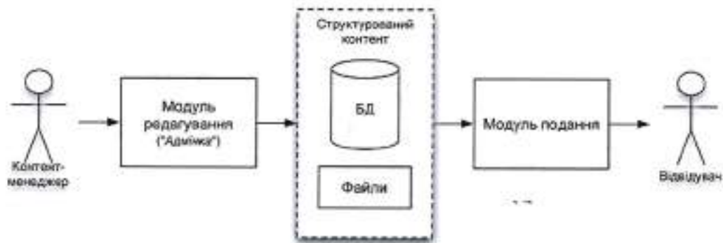
Рис. 2.1 «Схема архітектури системи управління контентом»
