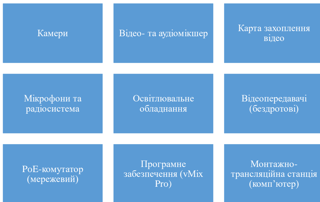
Рис. 2.2 – Основні компоненти системи технічного забезпечення роботи медіастудії «КРОК»
