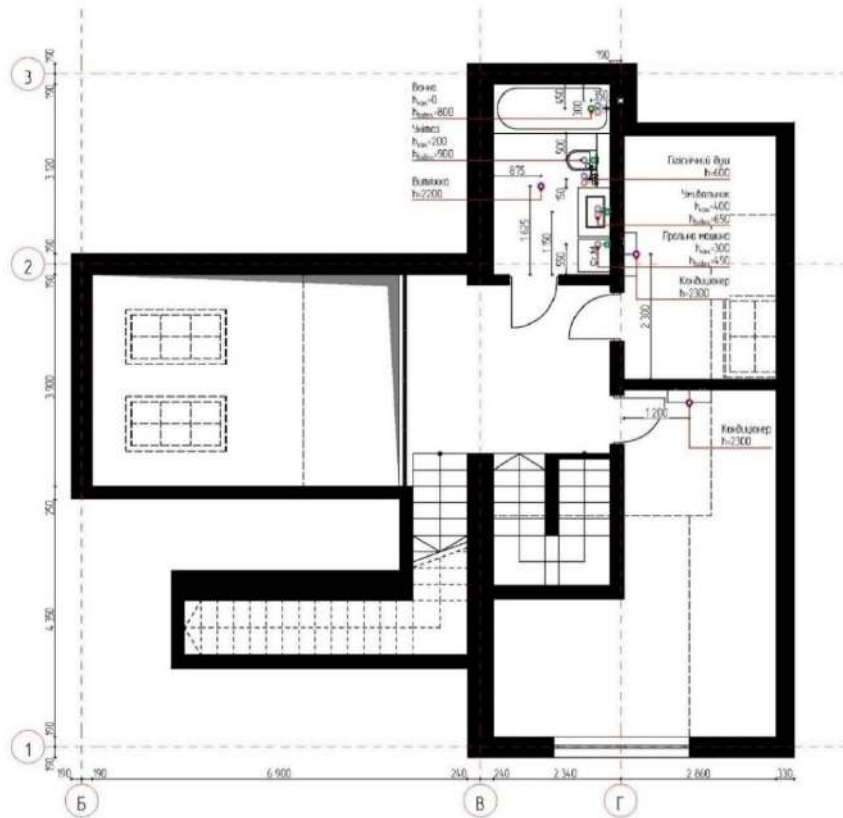
Рис. 3.3.4. План розміщення інженерійних мереж 2-го поверху (авторське креслення).
